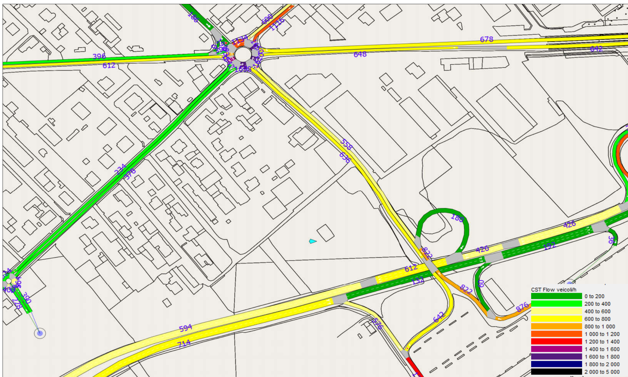
FIGURA 3.4b - SIMULAZIONI DINAMICHE - SCENARIO DI PROGETTO - ORA DI PUNTA DEL SABATO - FLUSSI VEICOLI/ORA TOTALI INCROCIO PROVINCIALE SARONNESE-CERRO MAGGIORE
